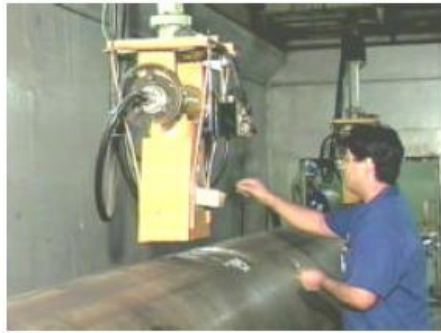
Inspecção radiográfica de soldas em tubos
